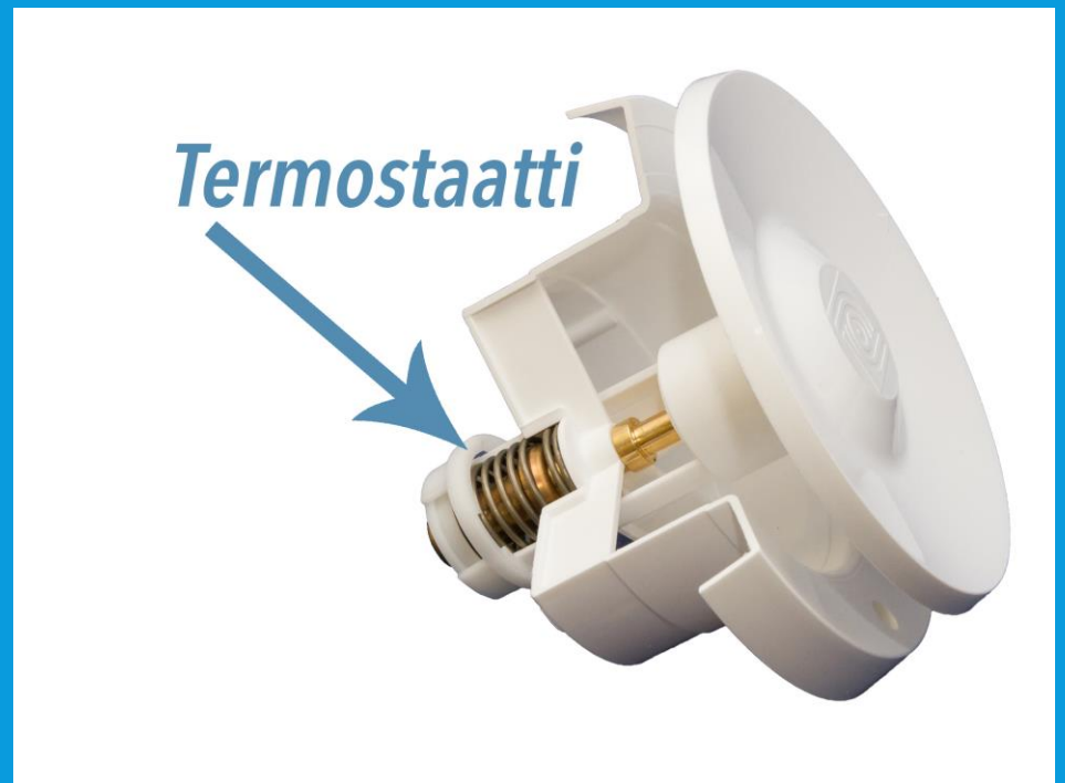
Ulkolämpötilan mukaan säätyvä korvausilmaventtiili
